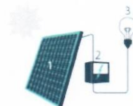
Zonnepanelen 1, Omvormer 2, Lamp 3 Elektriciteitspanelen
